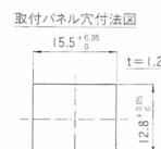
スイッチ挿入方向に対して、裏面をハリ面側とする
